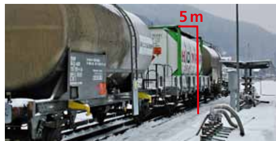
Ancien processus: le prélèvement d'échantillons avait lieu sans mesures de sécurité particulières au lieu de déchargement. Le potentiel de risque était élevé et une chute aurait pu causer des blessures graves.
