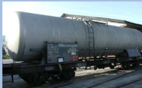
Kesselwagen 4-Achs min. 40'000 kg netto
