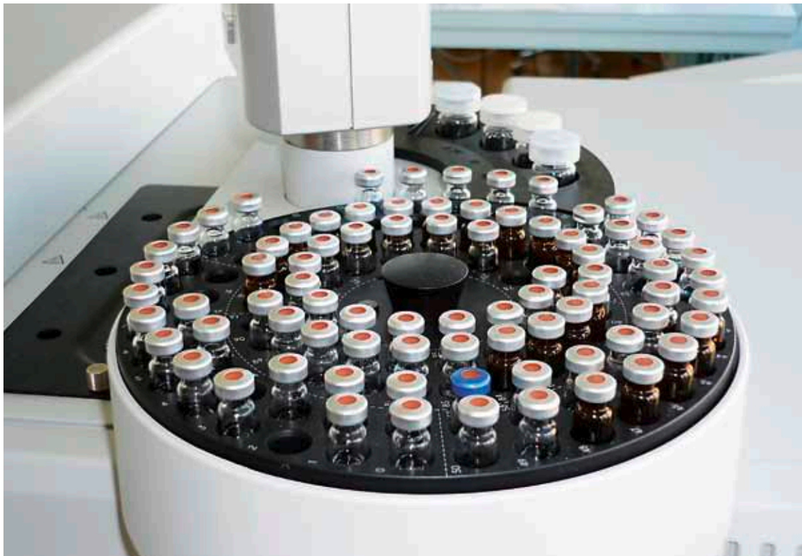
Il laboratorio della RFA utilizza il gascromatografo per determinare le sostanze volatili contenute nell'etanolo.
